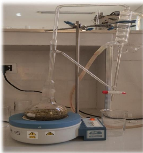
Figure II. 4. Photo représentant l'extraction de l'HE par hydro-distillation
