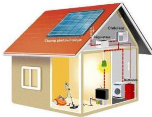
Fig1. 8 : Système photovoltaïque autonome [6]
