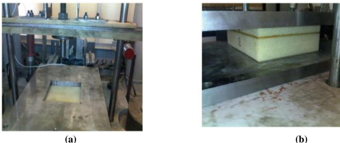
Figure.I. 22. Description de l'impact sur une structure sandwich multicouche par la machine d'essai au marteau-pilon..
