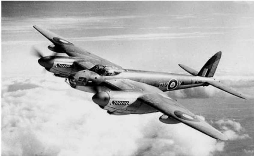
Figure.I.3 L'avion militaire Britannique ; Le Mosquito, en structure sandwich [8].
