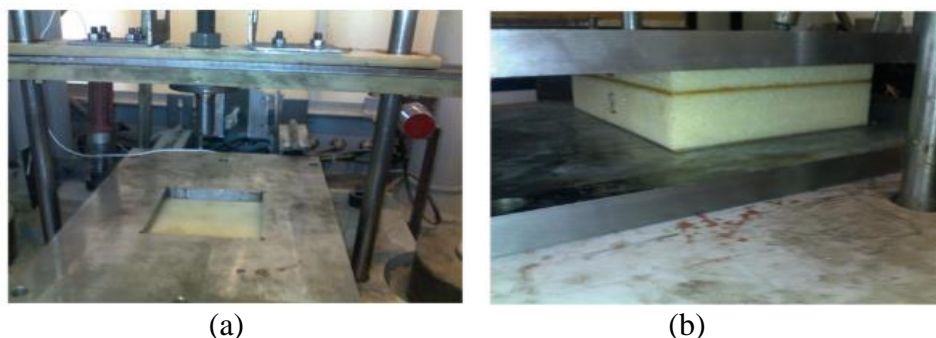
Figure.I. 32. Description de l'impact sur une structure sandwich multicouche multicouche par la machine d'essai à marteau-pilon.
