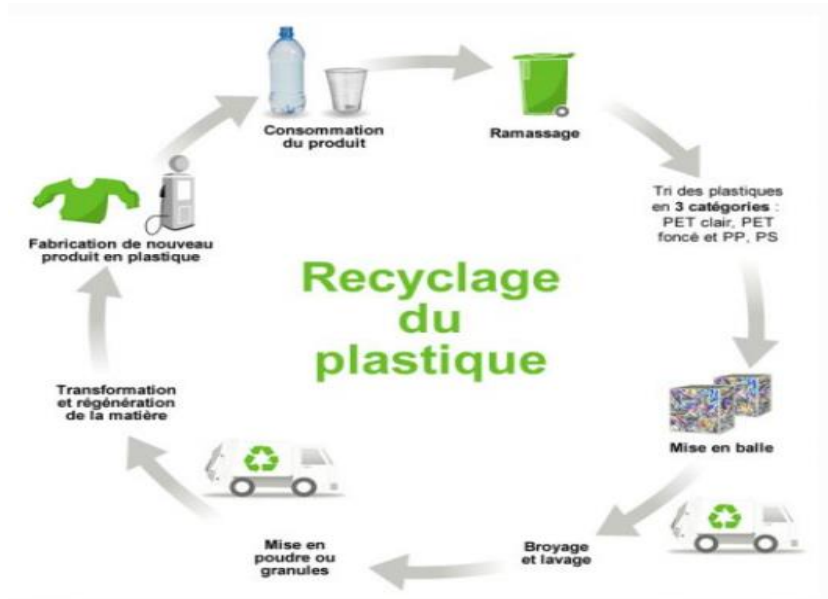
Figure (I. 2) : Etapes de recyclage du plastique [9]
