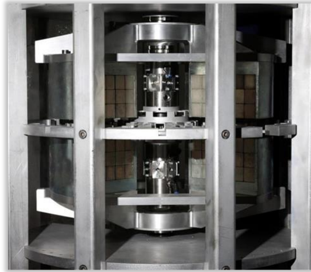
Figure V.1: Vue de côté du système magnétique et de la rotative soupape
