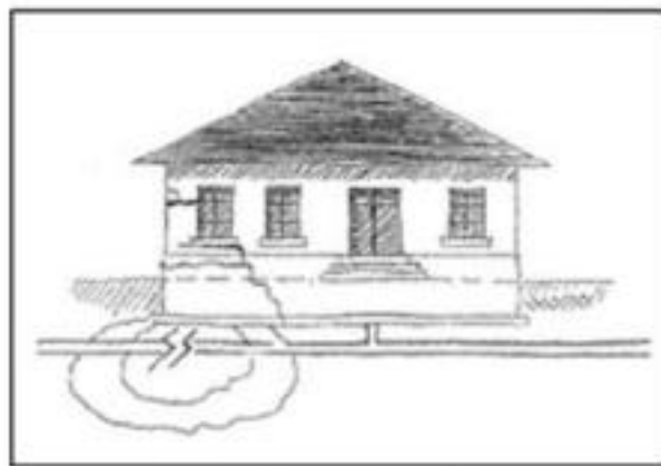
Figure VII.3: rupture de canalisations suite à un tassement uniforme
