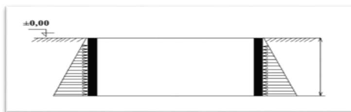
Figure VI.3.2 : Poussées des terres.
