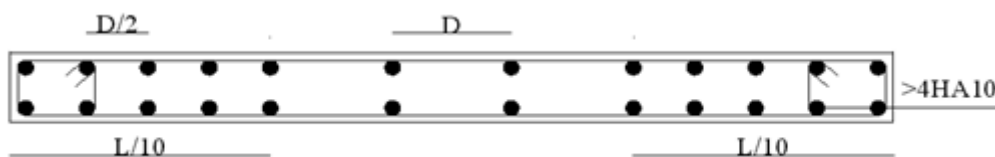
Figure V.5 : Dispositions des armatures verticales dans les voiles .
