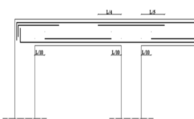
Figure V.6. Arrêt des barres.
