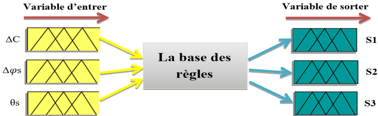
Figure III.10: structure du contrôleur flou pour redresseur à deux niveaux.
