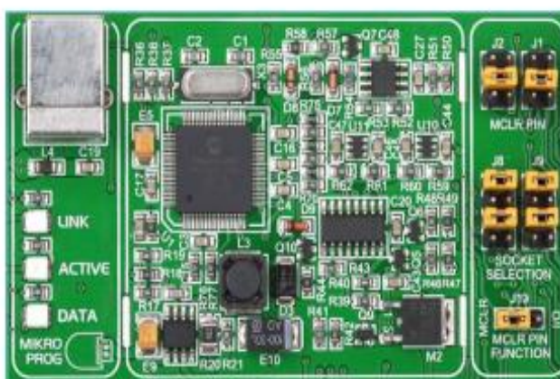
Photo 2. Sous le capot du programmeur/débogueur mikroProg intégré.
