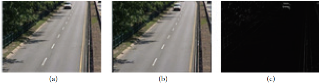
Figure 2.4: Alignement d'images et image de différence : (a) l'image à l'instant d'une séquence de trafic acquise avec une caméra fixe, (b) l'image obtenue après déformation de l'image à l'instant K+5 avec H, (c) la différence entre l'alignement images.
