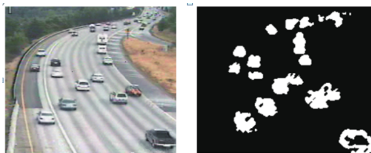
Figure 2.1: Véhicules en mouvement détectés, L'image de gauche est l'image originale, L'image de droite montre le résultat du véhicule détecté sur la voie.
