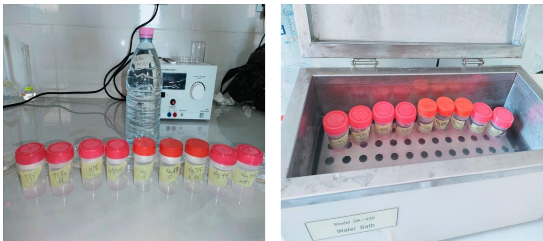
Figure IV.11 : Le test de la libération du diclofénac sodique à partir des microparticules chargées dans les conditions biomimétiques à 37 °C.
