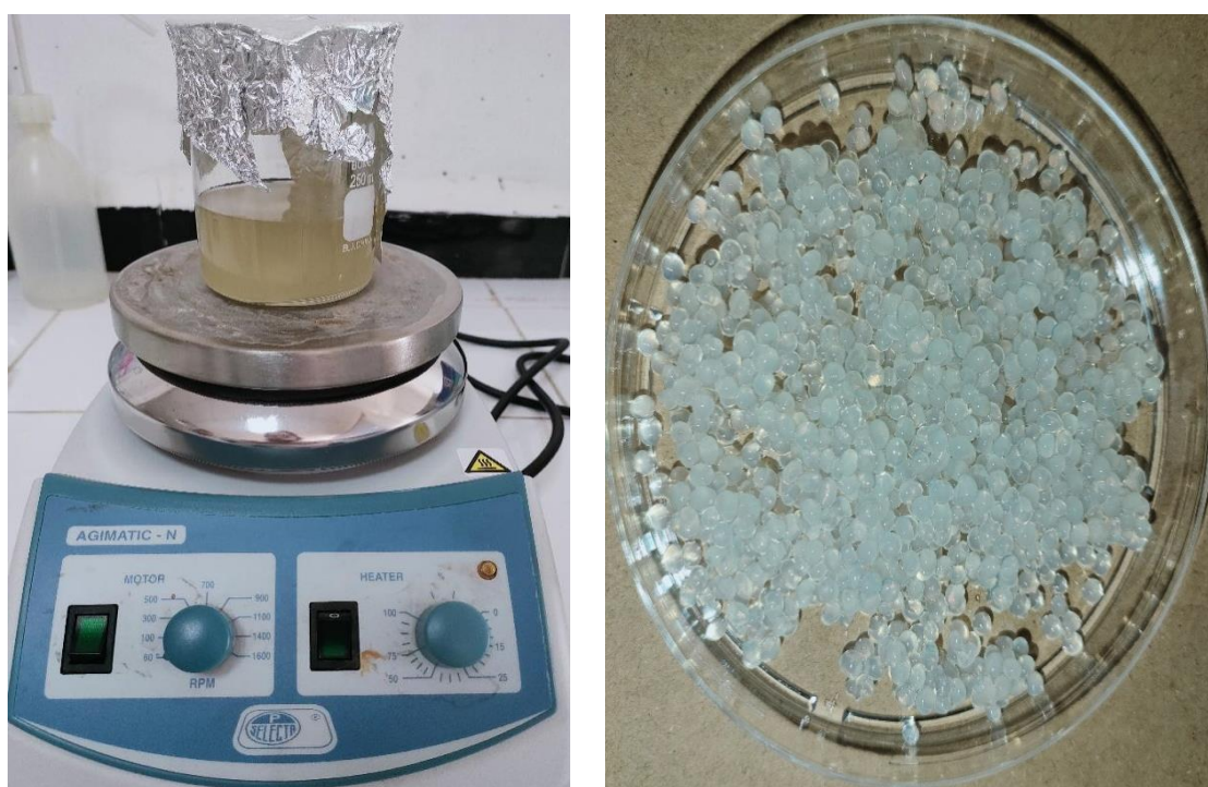
Figure IV.6 : Préparation de la solution d'alginate (5% p/v d'eau) et préparation des microparticules d'alginate de sodium vides.
