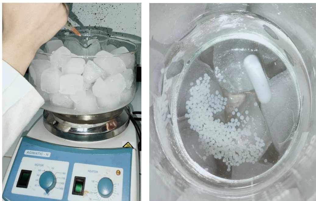
Figure IV.4 : Préparation des microparticules à base du chitosane vides.
