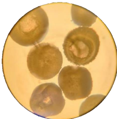
Figure IV.18 : Photo microscopique agrandissement x 0.1 des microcapsules vides à base d'alginate de sodium.
