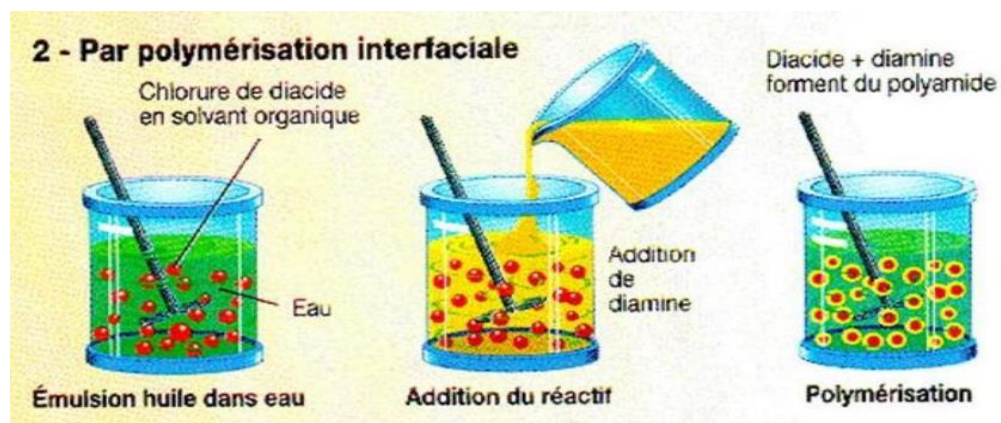
Figure I.5 : Les étapes de la polymérisation inter faciale [8].
