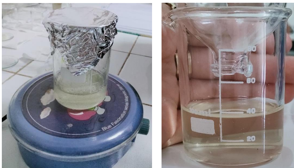
Figure IV.1 : Préparation de la solution de chitosane (2% p/v) et de la solution d'acide acétique (1% v/v).
