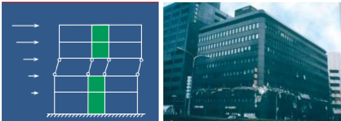
Figure 1.15 : les étages flexibles (Kobe, Japon, 1995)
