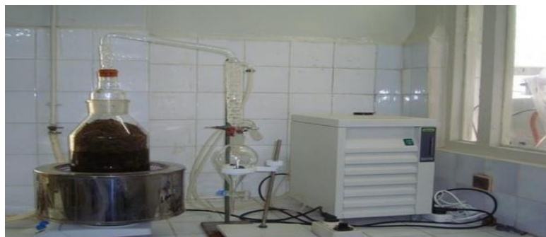
Figure I.9 : Montage d'extraction par la technique d'hydrodistillation [91]
