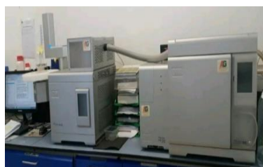
Figure III.7 : Photo représentant l'équipement de la CG-SM.(Centre de Recherche Scientifique et Technique en Analyses Physico-Chimiques).
