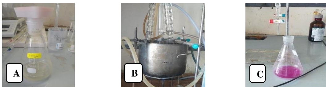
Figure III.6: Préparation du mélange de saponification (a- préparation de mélange ; b- montage à reflux ; c- titrage).
