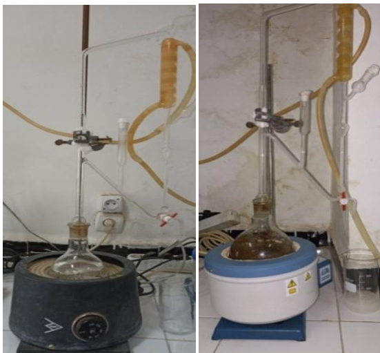
Figure III.8. Extraction des huiles essentielles par hydrodistillation.
