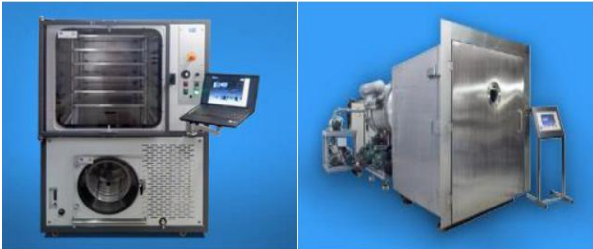
Figure I. 08: Lyophilisateur Pilote LPCPLS15 et lyophilisateur de production. [29]
