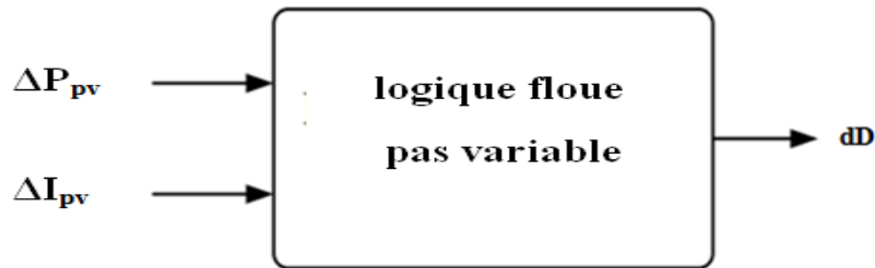
Figure 2.19 : Bloc du calculateur de pas variable FLC proposé
