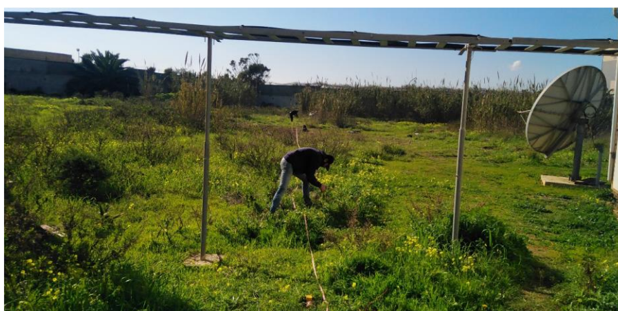
Figure 14 : Photographie d'implantation des géophones sur site
