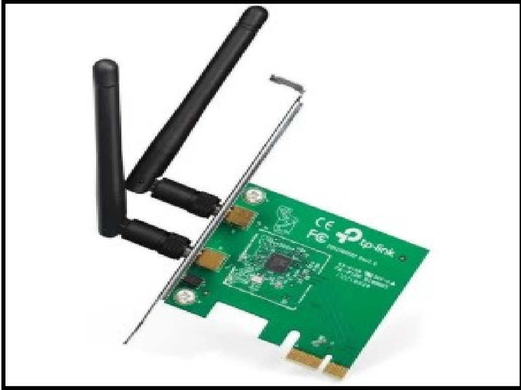
Figure I. 9. Carte réseau PCI [16].
