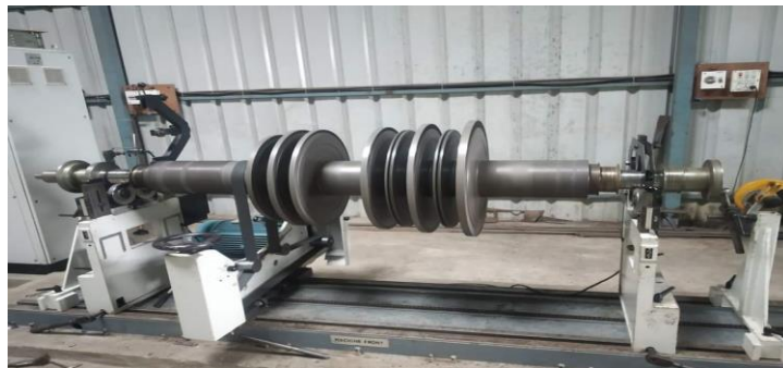
Figure1. Rotor à plusieurs étages sur machine d'équilibrage pour l'industrie.
