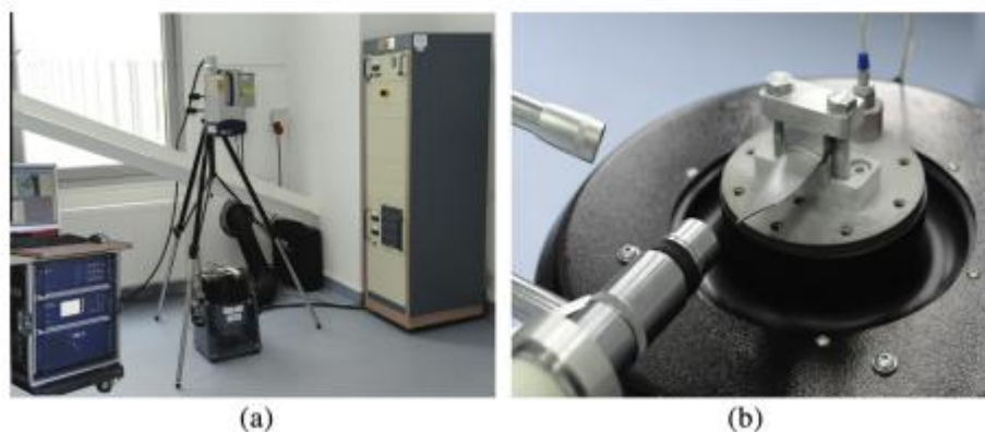
Figure I.38. Vue du système de vibration utilisé dans les études expérimentales pour créer les conditions de fatigue à haut cycle (a) et la lame montée horizontalement sur la tête du vibreur (b) [25].
