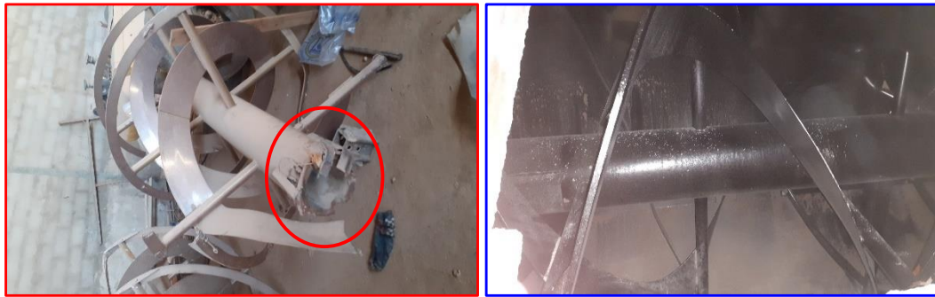
(a) : Un mélangeur endommagé et usé en raison de la fissure
