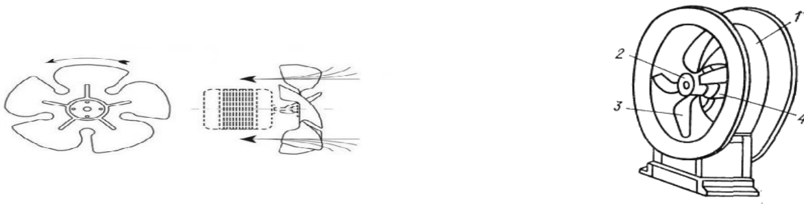
Figure I 4: Déplacement d'air produit et les composants d'un ventilateur axial
