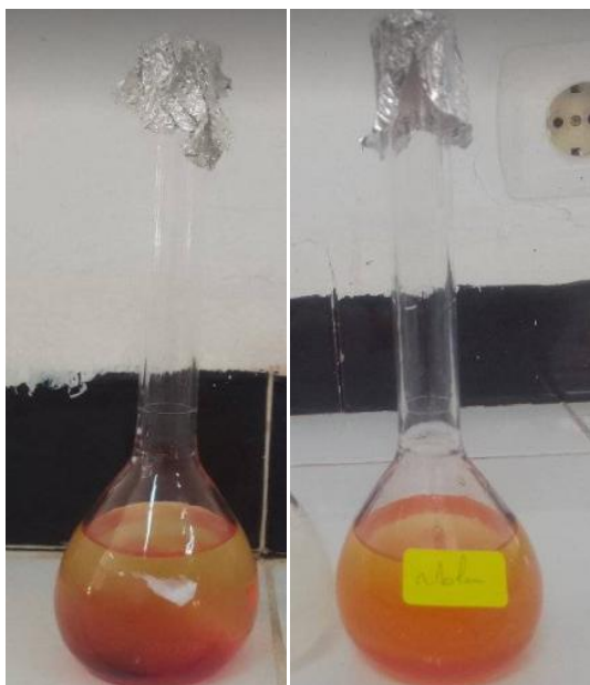
Figure IV.17 : Détermination de L'indice de peroxyde.
