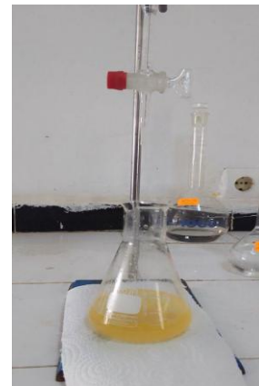
Figure IV.16 : Titrage par thiosulfate de sodium.
