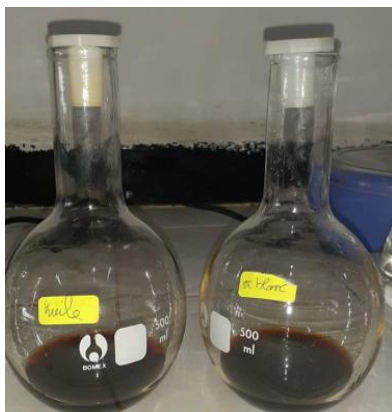
Figure IV.15 : Détermination de L'indice d'iode.
