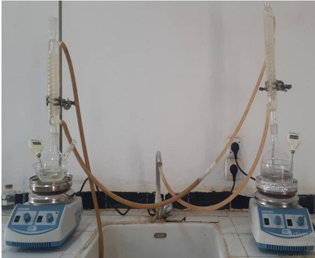
Figure IV.13 : Détermination de l'Indice d'ester
