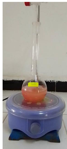
Figure IV.18 : Titrage par thiosulfate de sodium.
