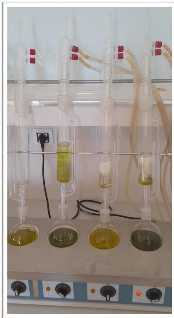
Figure IV 9: Extraction des concrètes par soxhlet.
