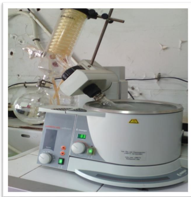
Figure IV 10: élimination du solvant par le rotavapeur
