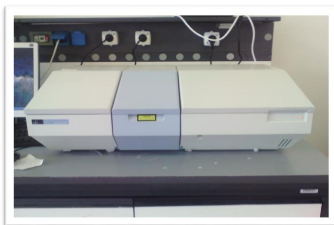
Figure IV 5: Appareil de FTIR de type SHIMADZU 8400.
