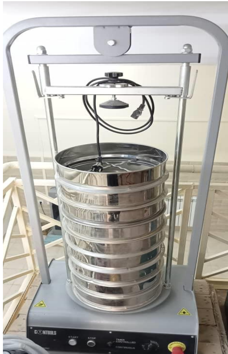
Figure II.5: Tamisage de matériau concassé pour l'obtention de différentes classes granulaires recyclées.
