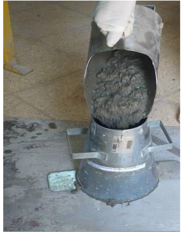
Figure II.15: Réalisation de l'essai de l'ouvrabilité
