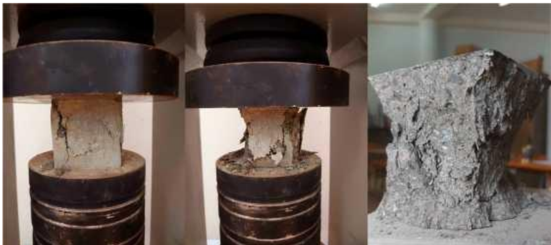
Figure II.19 : Rupture des éprouvettes.
