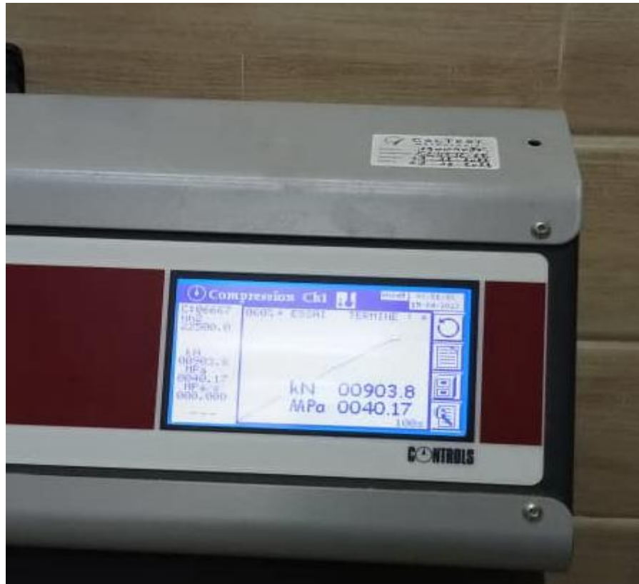
Figure II.3 : Les résultats de l'écrasement des éprouvettes.
