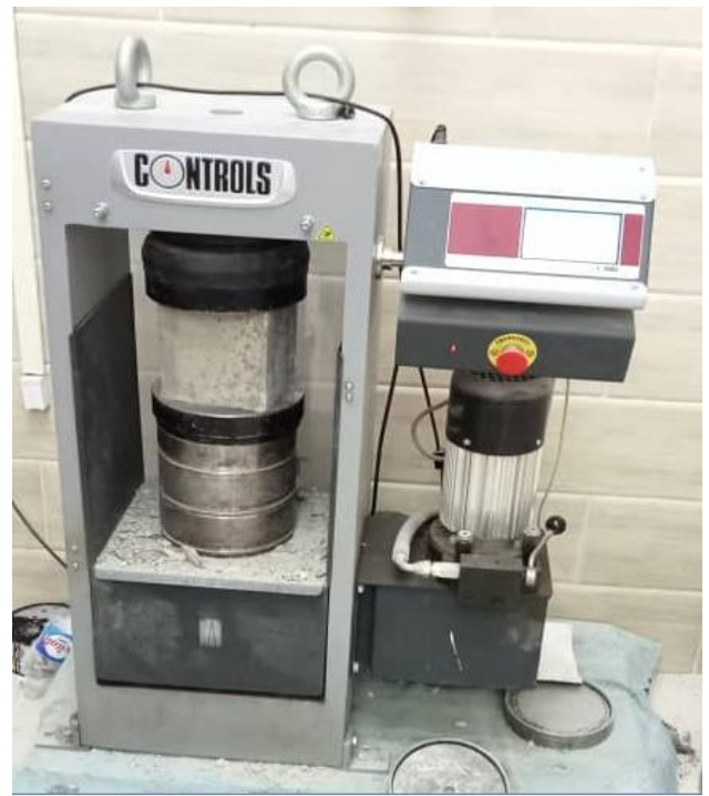
Figure II.2 : l'écrasement des éprouvettes.
