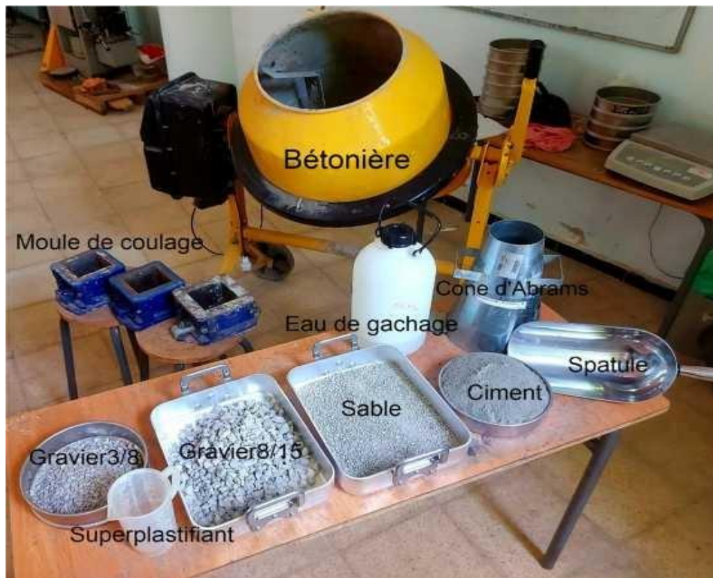
Figure II.11 : Matériel utilisé pour la formulation d'un mètre cube de béton recyclé.
