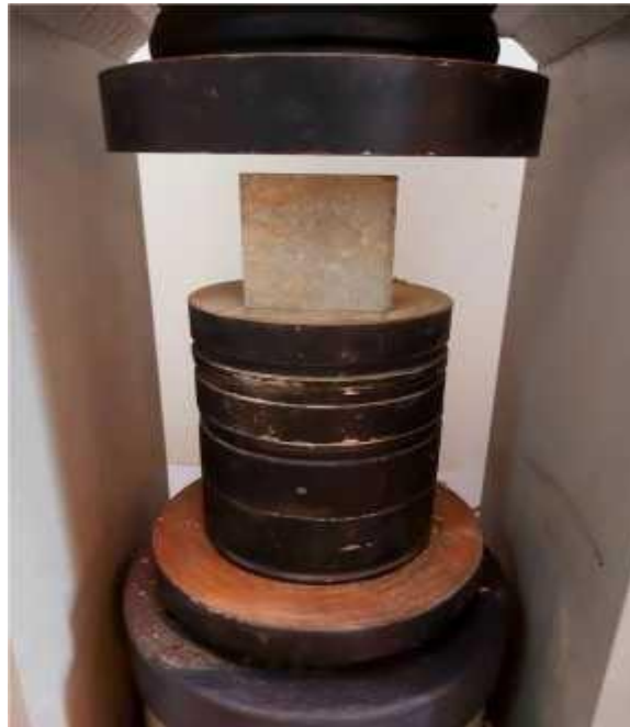
Figure II.18 : Installation des éprouvettes sur la machine.
