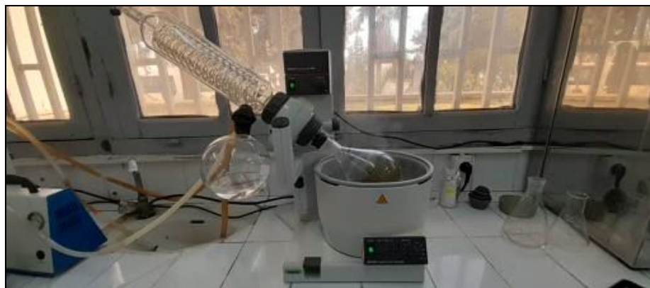
Figure 11: Élimination de solvant par évaporation rotatif (original, 2024)
