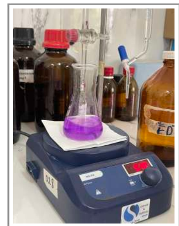
Figure 20 :Titration par EDTA du calcium (Photo originale, 2024)
