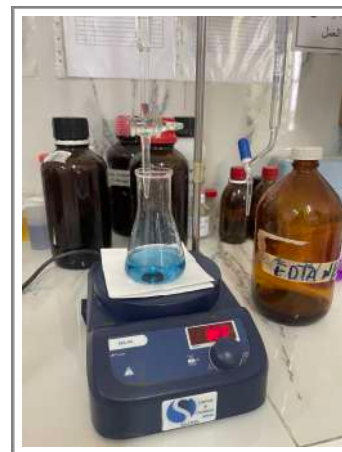
Figure 21: Titrage par EDTA du calcium magnésium (Photo originale, 2024)
