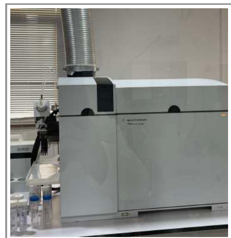
Figure25: spectrométrie de masse associée à un plasma d'argon à couplage inductif (ICP-MS) (Photo originale, 2024)
