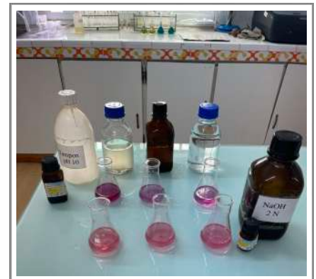
Figure 19 :Préparation des échantillons à titrer (Photo originale, 2024)
