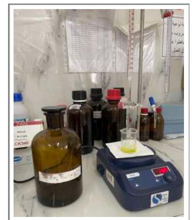
Figure23: titrage des chlorures (Photo originale, 2024)
