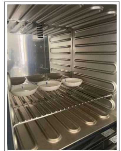
Figure 15 : Séchage des capsules dans l'étuve (Photo originale, 2024)
