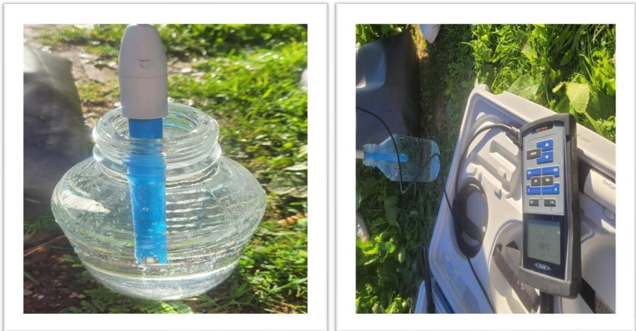
Figure 7 : la mesure des paramètres physico-chimiques par multi paramètre
