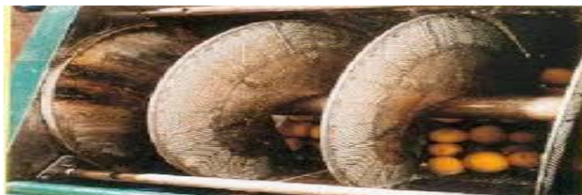
Figure 6: Montage de l'expression à froid.
