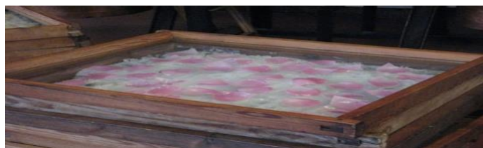
Figure 4 : schéma d'extraction par l'enfleurage(Neves 2011).
