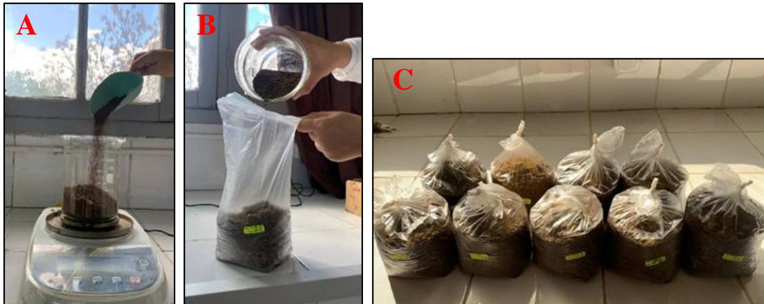
Figure 23 : Pesage du sol (Originale). A : Prise de poids de l'échantillon ; B : Déversement de l'échantillon dans un sac; C : Sacs contenant le sol pesé.
