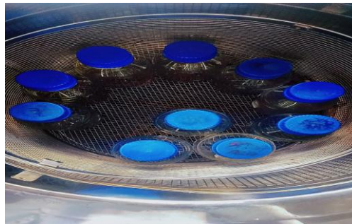
Figure 17 : Stérilisation des milieux de culture dans l'autoclave (Photo originale, 2025).
