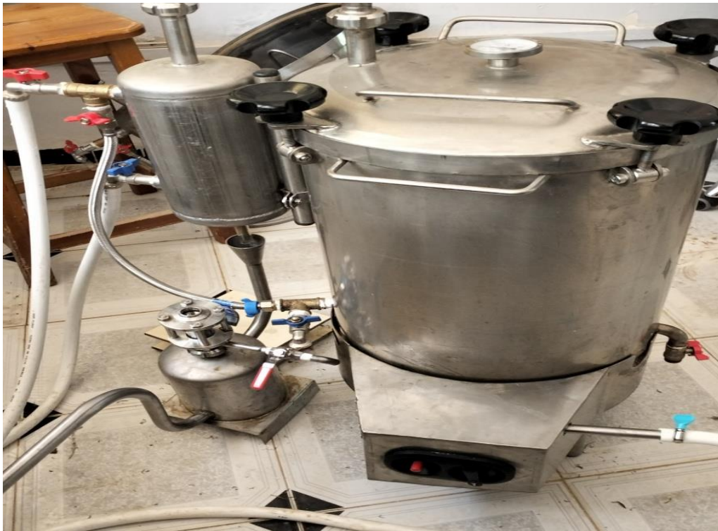
Figure N° 13: L'appareillage d'extraction des HEs de Menthapulegium par entraînement à la vapeur d'eau.
