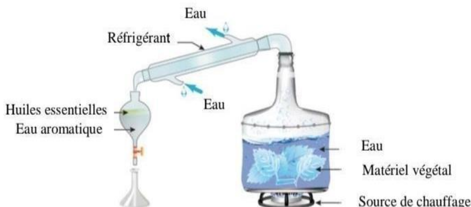
Figure N° 5: Représentation schématique de l'hydrodistillation (Hashemi et al., 2018).
