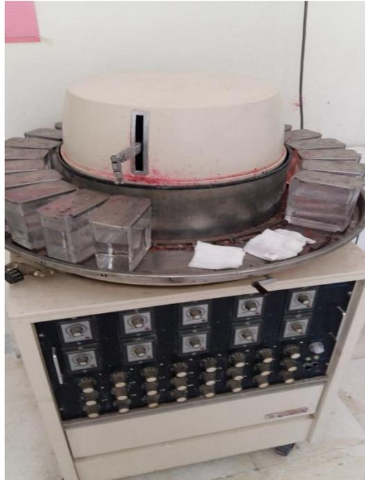
**Figure 08** : automate de coloration standard de type sakura-cyto-stain
