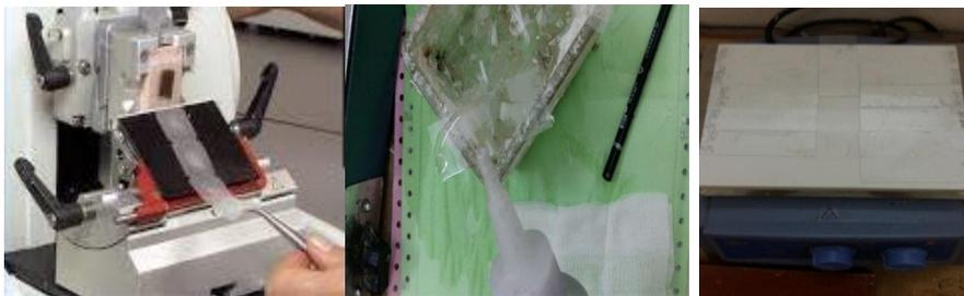
**Figure 06** : microtomie et étalement.
