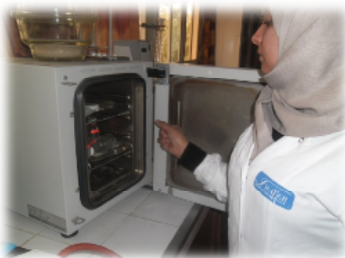
Figure 26: Séchage de la phase organique.
