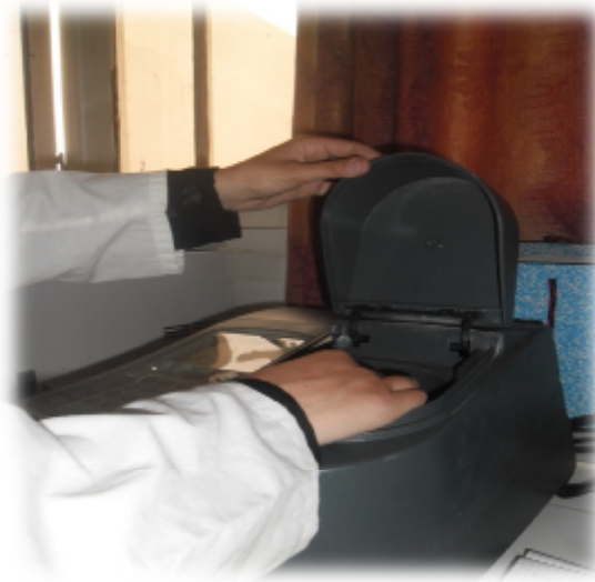
Figure 23: Lecture de la densité optique
