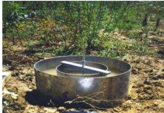
b- Infiltromètre à double anneaux
