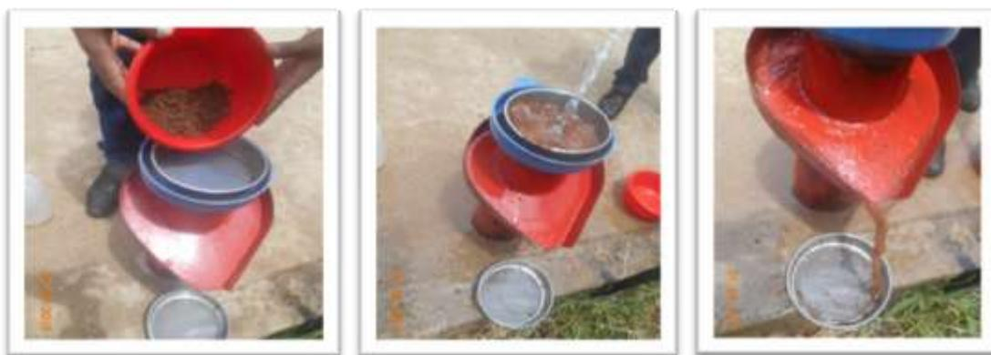
**Figure 12:** Extraction de nématodes à kystes à l'aide de l'appareil de Fenwick (Original).
