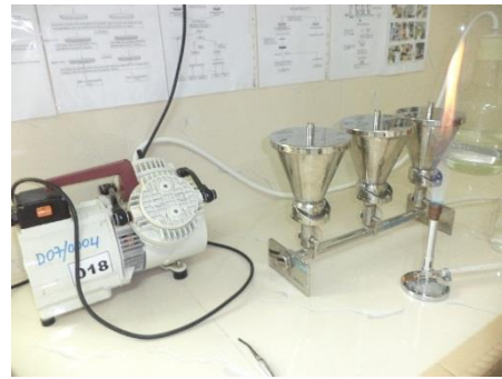
Photo 6 : Rampe filtrante et bec benzène
