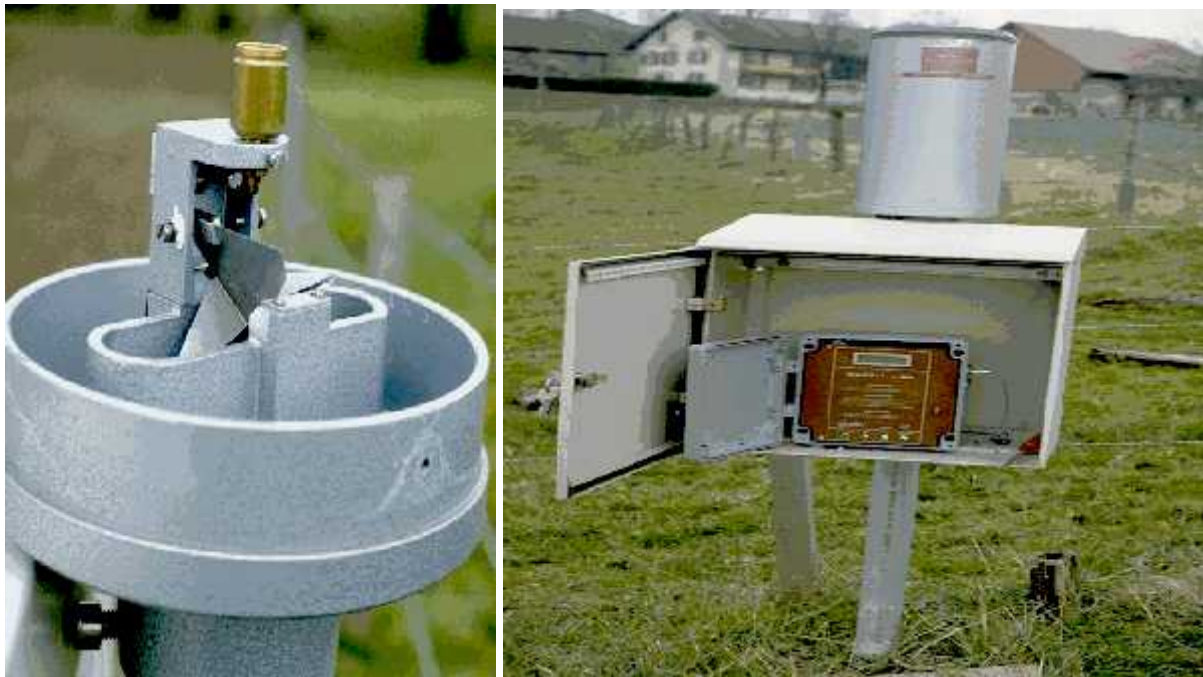
Figure 2.5. Pluviographe, augets basculeurs et système d'enregistrement MADD.
