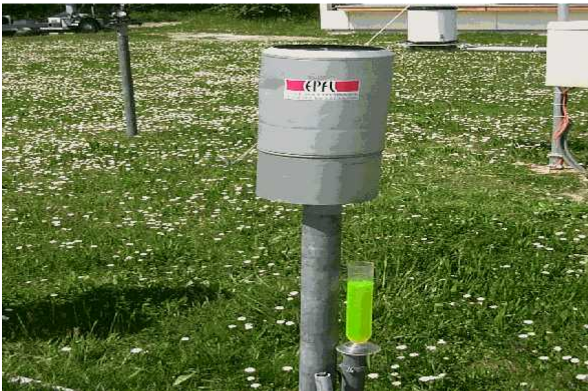
Figure 2.5. Pluviomètre de Hellman
