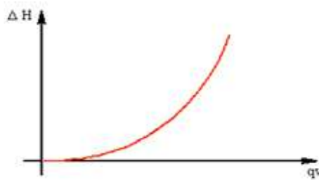
Figure VI. 8: Caractéristique d'un réseau fermé
