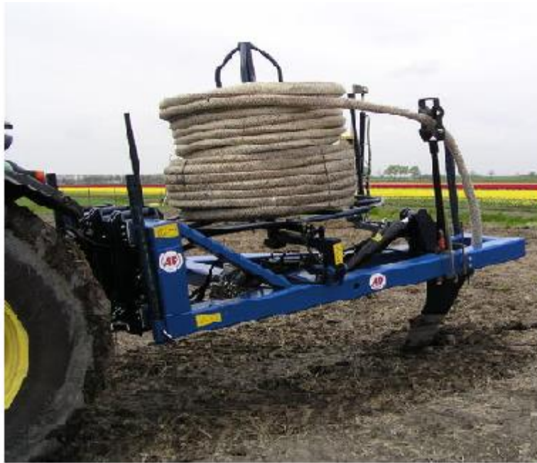
Fig 20: Draineuse montée sur tracteur Profondeur 2 m
