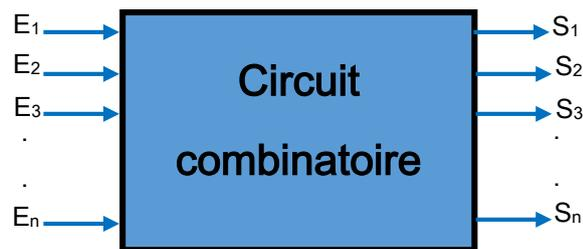
Les circuits combinés peuvent être utilisés pour créer d'autres circuits plus complexes. Voici quelques exemples de circuits combinatoires : Demi Additionneur, Additionneur complet, Comparateur, Multiplexeur, Démultiplexeur, Encodeur et Décodeur...etc.
