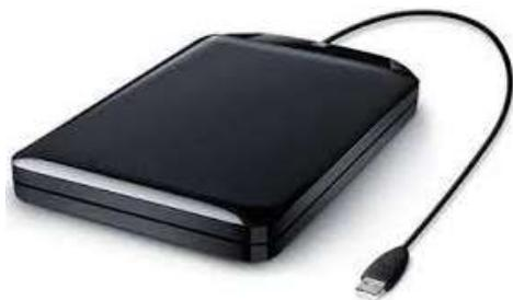
peuvent être connectés directement via USB. Sa capacité de stockage varie de 250 Go à plus de 1 To. L'inconvénient de ce support est qu'il est fragile, là où un disque dur interne est à l'abri dans la machine, le disque dur externe risque à tout moment de tomber ou de subir de trop grandes vibrations, ce qui peut entraîner un dysfonctionnement irréversible. La
