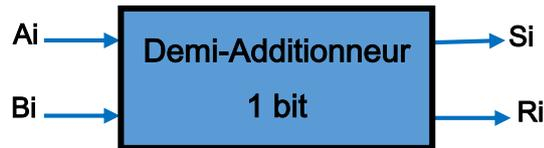
2-établir la table de vérité d'un additionneur complet à 1bit qui calcule la somme de deux nombres binaires ( $S_i = A_i + B_i + R_{i-1}$ ) et la retenue sortante. Puis, établir le schéma logique de ce demi-additionneur.
