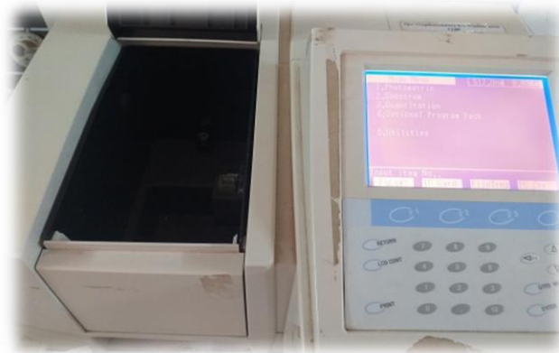
Figure III.8 la lecture de l'absorbance par UV-VISIBLE.
