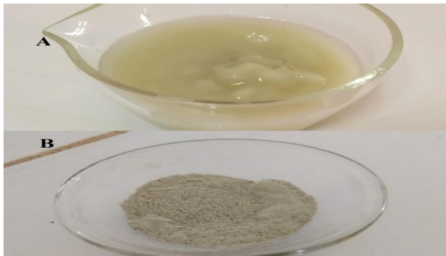
Figure 4.1. Adsorbant mont-NiO: avant séchage (A) et après séchage et broyage (B).
