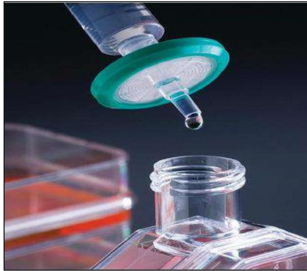
Figure n° 09 : Filtration sous pression
