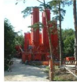
**Fig.49** Centrale de fabrication de coulis
