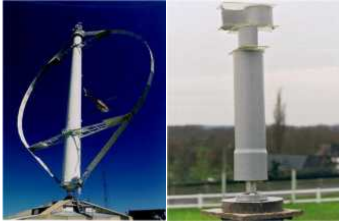
Éolienne de type Darrieus.
