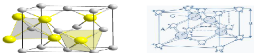
Figure I.1 : Structure Cristalline du GaAs
