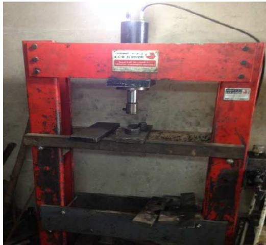
Figure 4.6: Photo de la presse hydraulique
