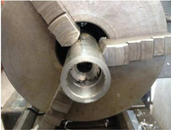
Figure 4.12 : Photo du piston moteur au tour
