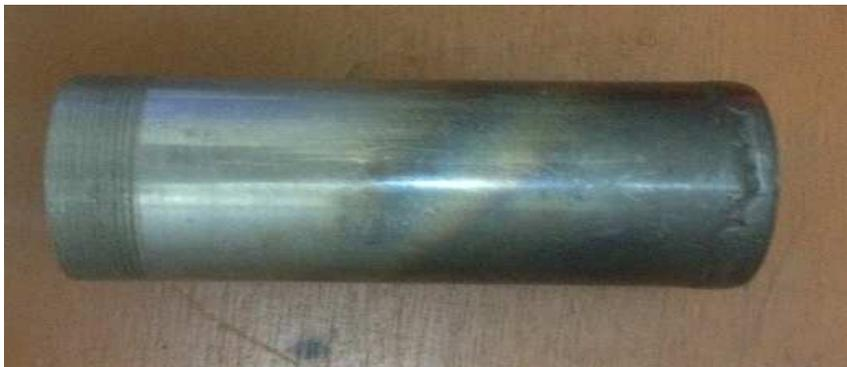
Figure 4.15 : Photo du Cylindre du piston deplaceur
