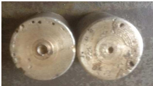
Figure 4.25 : Fissures causé par les hautes températures
