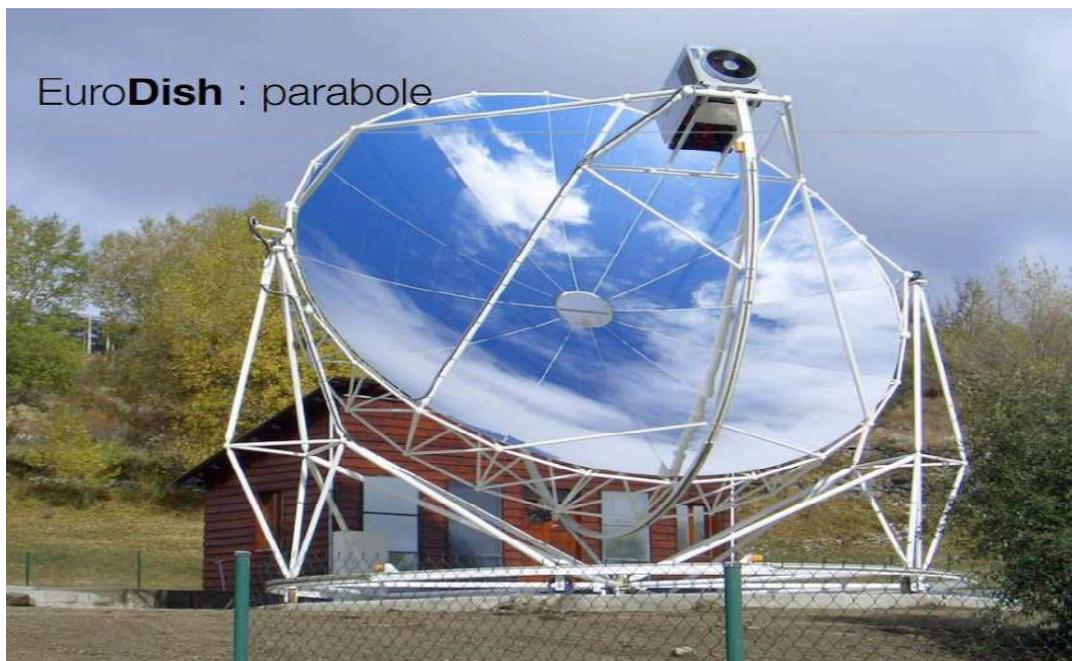
Figure 1.8 : La parabole Stirling solaire du projet EuroDish (Nepveu et al. 2006)
