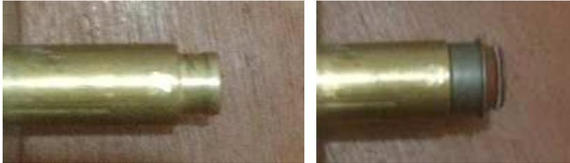
Figure 4.20 : Photo du coussinet réducteur des frottements
