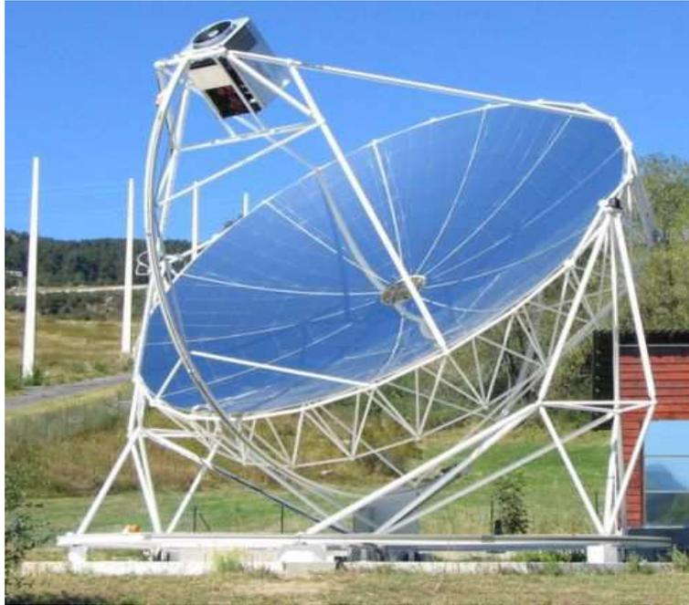
**Figure 3.4 : Système Dish-Stirling ( EuroDish à Odeillo (66))**
