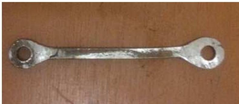
Figure 4.16 : Photo de la Bielle du piston deplaceur
