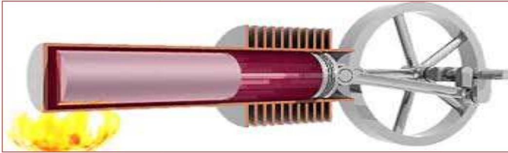
Figure 1. 6 : Moteur Stirling de configuration beta (Article de Bonnets,S (2005))
