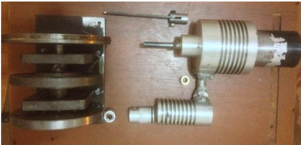
Figure 4.23 : Photo des pièces assemblées pièces réalisé du moteur Gamma N°3
