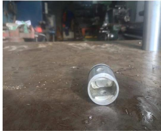
Figure 4.13 : Photo du piston moteur
