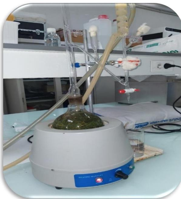
**Figure 18 :** Hydrodistillateur de type Clevenger (Original, 2022)
