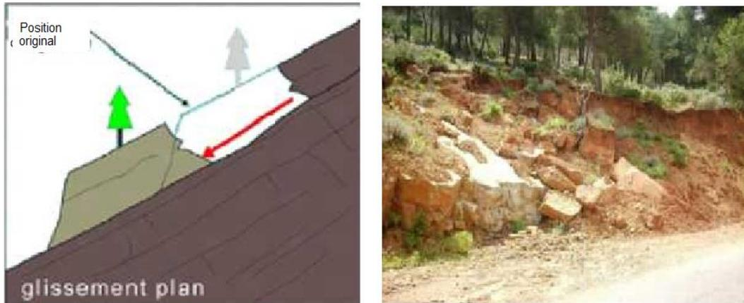
(a) Mécanisme de glissement plan (b) Exemple d'un glissement plan, Ténès Algérie.
