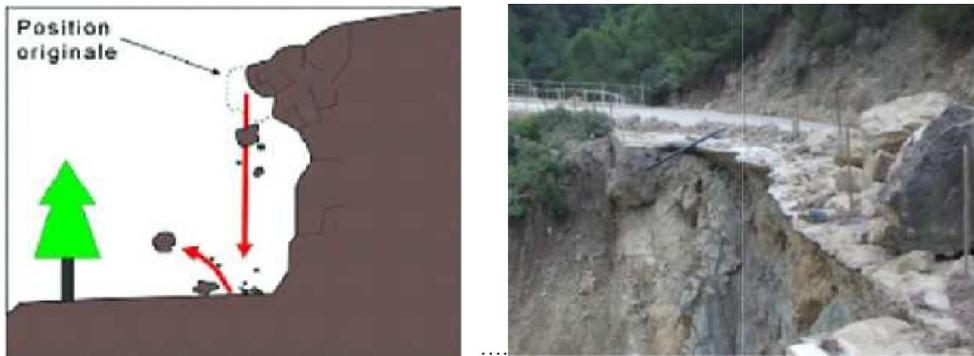
(A) Le mécanisme de l'éroulement (B) Eroulement (Damous, Algérie)
